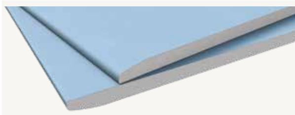
Lastra ad alta densità e resistenza costituita da un nucleo in gesso le cui superfici e bordi longitudinali sono rivestiti di speciale cartone perfettamente aderente. Sono caratteristiche intrinseche di questa lastra l'alta resistenza agli urti e un'elevata durezza superficiale. Ideale per il rivestimento di pareti, contropareti e controsoffitti con reazione al fuoco classe A2-s1, d0. Adatta per ambienti umidi come bagni e cucine e per garantire ottime prestazioni di isolamento acustico.
