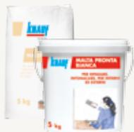
Malta in polvere monocomponente a base di speciali leganti, sabbie fini selezionate e additivi che la rendono particolarmente indicata come rasatura di intonaci tradizionali. Adatta a utilizzo in interni ed esterni. Resa 1,3 kg/m<sup>2</sup> per 1 mm di spessore.
